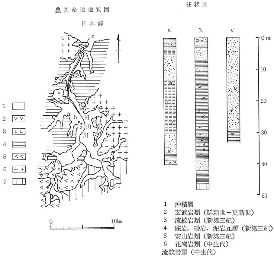
図2-6-34 豊岡盆地地質図および地質柱状図
