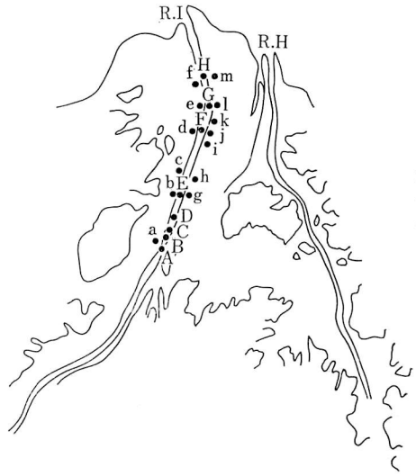
図2-7-12 (a) 飯梨川河床と両岸における標高測定地点 (図2-7-12 (b)参照)
