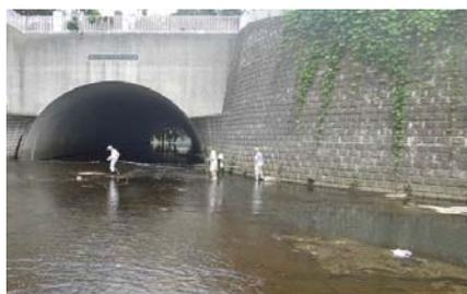
平成 25 年 8 月 3 日の河川流量調査では二俣川の流量は  $10,000 \text{ m}^3/\text{日}$ 、帷子川の流量は  $22,000 \text{ m}^3/\text{日}$  でした。
