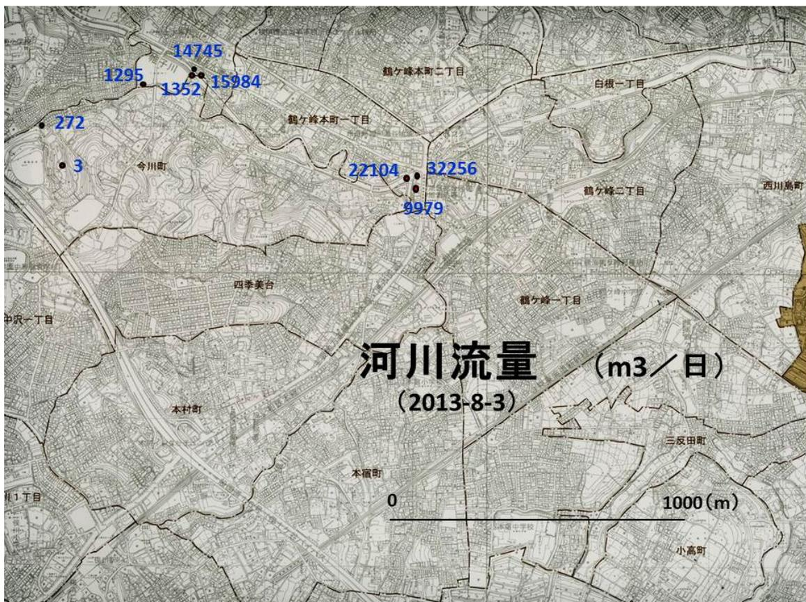
図-13 帷子川の流量測定結果 (流量の単位は :  $\text{m}^3/\text{日}$ )
