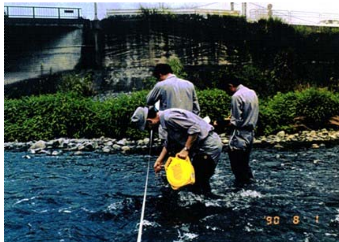
図3 流量調査風景 盆地内の雨水、湧水、排水を集めて盆地外へ流出する金目川 (流量 約16万m 3 /日、神奈川県温泉地学研究所、環境科学センター)
